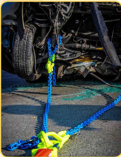
这些是在发生严重事故时决定成功或失败的秒数。车辆的极端变形和现代设计使救援人员的工作日益复杂化。简单有效的是使用STABLOX链式救援套件。已经在斯堪的纳维亚半岛成功标准化的方法和设备实现了快速且节省患者的救援。将消防队的工作空间向外拉，可以实现医疗救助和技术救援的并行工作。链式救援可以在各种事故情况下非常成功地使用，例如正面碰撞，侧面和后部碰撞。对于更广泛的应用，链式救援套件包括两个安全钩和一个铸造钩，它可以钩在系统中安装的吊钩上。为了在打捞作业期间不必直接对事故受害者进行工作，并且可以通过两个紧急服务进行施工，通过使用链式救援来减少部署的部队的身体和精神压力。
