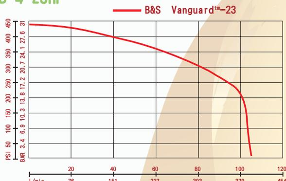
**WATERAX BB-4-23**泵由高性能4级泵端与强大的Briggs & Stratton 4冲程23 HP发动机结合而成，能实现高达440 PSI（30.3 BAR）的压力，流量达到106 GP-M（401L /分钟）。该泵动力强劲，所以在高层建筑、远距离送水、山区高空消防等都广泛应用。**WATERAX BB-4-23**泵可作为串联和并联泵的源泵运行，同时也是直接供水线消防，远程洒水，喷水灭火系统的最佳选择，是滑动装置的流行选择。
