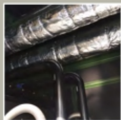
排气管 装有隔热保护装置， 防止操作人员烫伤
