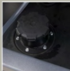
油箱检查口 用于在维修期间检查油箱
