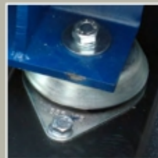
防震垫 减弱由设备自身引起的振动
