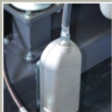
发动机加热器 在寒冷环境下更容易启动
