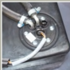
自动停止系统 燃油不足时可自动停止机器
