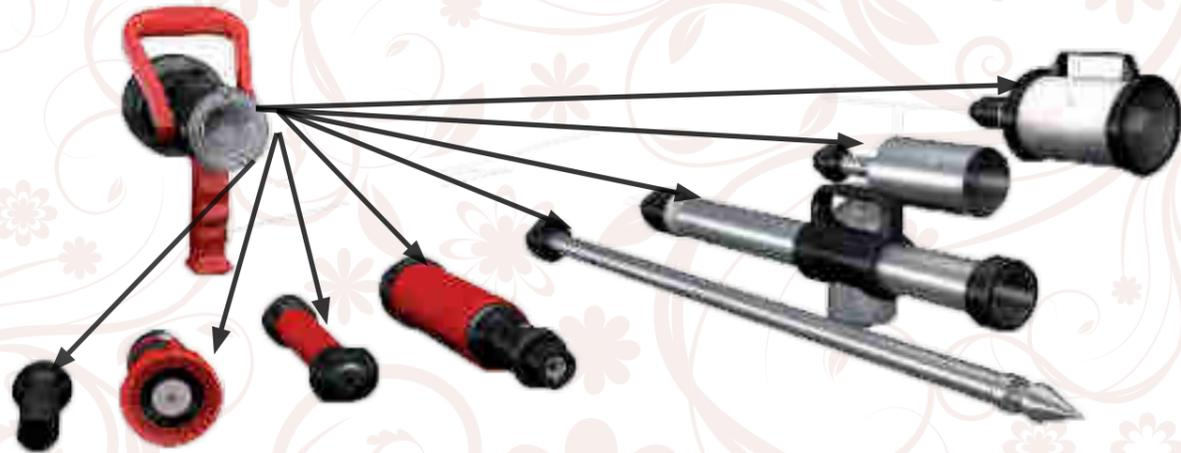
用户使用TURBO-TWIST系列多头水枪时，可以在数秒内快速更换枪头，以满足当前灭火情况的要求。当与各式各样专门用途的枪头配合使用时，带卡口连接的开关阀门瞬间变成了多功能消防枪。可提供针对所有标准应用的枪头，例如空心流和实心流枪头，以及可提供泡沫枪和适用于专门用途的专门配件，从而让您尽享灭火的最大灵活性，同时也能节省消防车上的空间。
