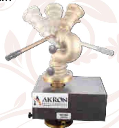
**3678型电控工业消防水 / 泡沫两用炮**系统被设计为一个紧凑的系统，它在多种恶劣环境下也可提供优越的性能。该系统是工业灭火、蒸汽降温控火和其他固定场所消防应用的理想选择。CONQUEST能够通过一个4英寸（100MM）的水道送出高达2000 GPM（7600 LPM）的水流。
