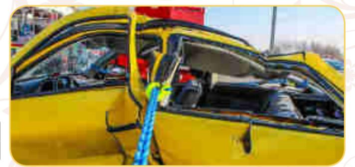
这些是在发生严重事故时决定成功或失败的秒数。车辆的极端变形和现代设计使救援人员的工作日益复杂化。简单有效的是使用STABLOX链救援套件。已经在斯堪的纳维亚半岛成功标准化的方法和设备实现了快速且节省患者的救援。将消防队的工作空间向外拉，可以实现医疗救助和技术救援的并行工作。炼式救援可以在各种事故情况下非常成功地使用，例如正面碰撞，侧面和后部碰撞。对于更广泛的应用，炼式救援套件包括两个安全钩和一个铸造钩，它可以钩在系统中安装的吊钩上。为了在打捞作业期间不必直接对事故受害者进行工作，并且可以通过两个紧急服务进行施工，通过使用炼式救援来减少部署的部队的身体和精神压力。
