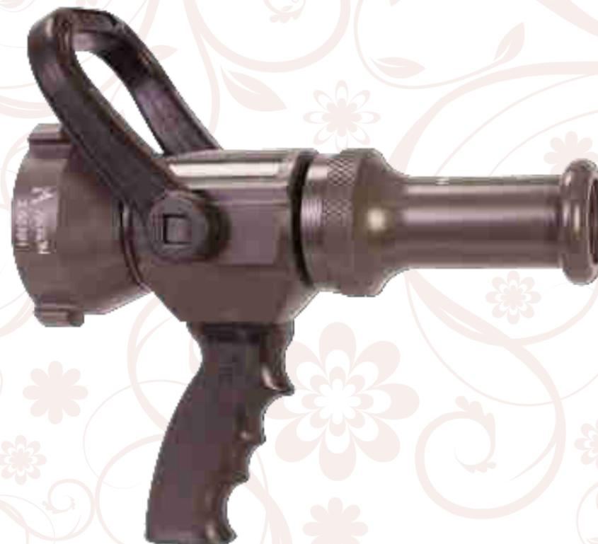
1446型直流开关水枪实心直流水枪，阿密龙专利的PYROLITE表面处理的直流开关水枪。配有手持把手。可实现低操作压力，高流量的直流喷射。50PSI入口压力下可实现近400GPM（1500LPM）。
