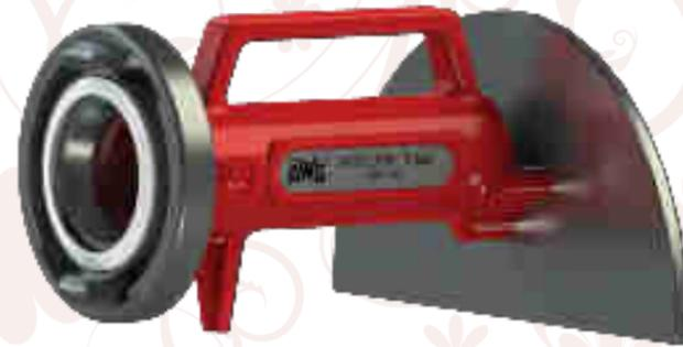
用于建立大型水幕或水墙，以防止气体、烟雾侵入和使物体冷却。该装置可以利用水压稳固站立，因此在使用过程中无需人力监控。此外，可以多个装置并排连用形成更宽的水屏障。
