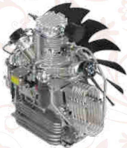
曲轴的轴承具有滚轮，非常坚固，且欧洲制造，保证了压缩机的长寿命。油泵通过过滤器和可以吸收润滑油中存在的任何金属的磁铁清除杂质，为机体的内部工作提供恒定的润滑。压缩空气冷却通过级间不锈钢冷却盘管获得。
