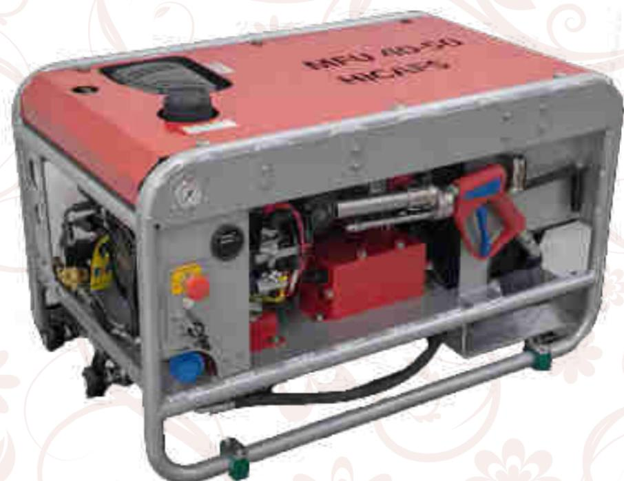
电动高性能消防系统，适合安装在轻型卡车，拖车，船上等。可快速从水或雾中切换到CAFS泡沫。CAFS由可再填充的压缩气缸产生，适用于高达6.000升的泡沫。强大的流速和高工作压力，确保安全的火灾距离和多种应用。集成卷轴上30米的消防水带。可与不同形状和大小水箱组合。
