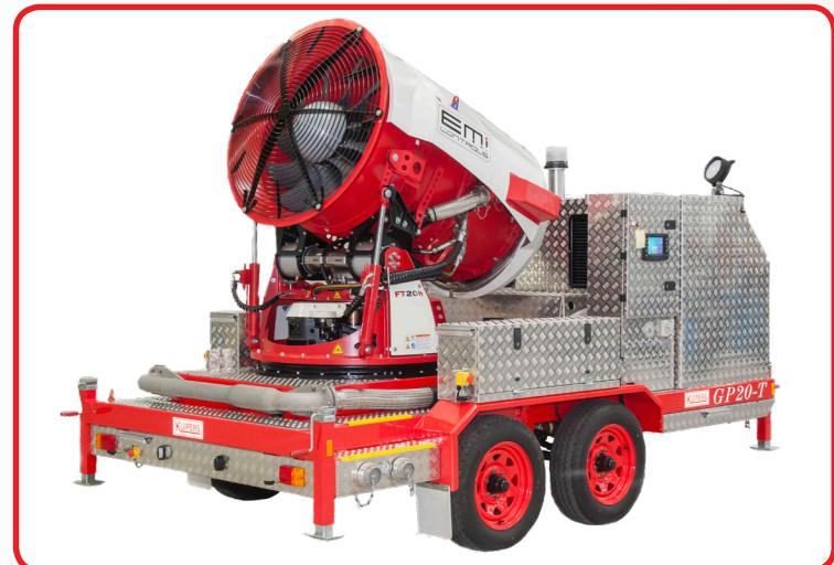
「GP20-T」是一款拖车式多功能排烟消防炮，采用细水雾技术，与消防涡轮风机和消防水炮相结合。通过显示屏或无线遥控进行操作，非常灵活，用途广泛，如控制涡轮风机移动的方向、平台的升降、涡轮风机的排风速度，以及消防炮（位于涡轮风机中间）的各种出水模式。涡轮风机配有喷嘴环，可将水雾化成细水雾。这种水或水/泡沫颗粒物质由螺旋桨驱动。水雾可快速地移除火中热量并显著降低温度，有效扑灭大面积的火灾。
